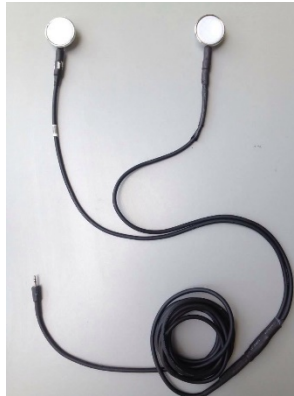
Fig. 3 Transductor diferencial diseñado en UIAP.
